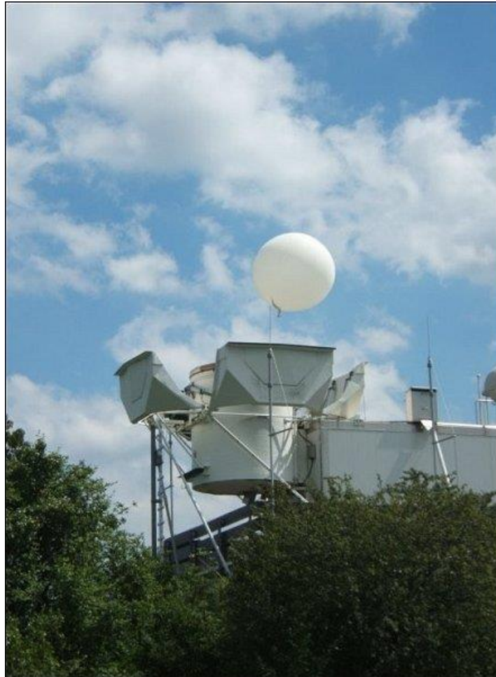
Automatisierter Start eines Wetterballons mit Radiosonde vom Stuttgarter Schnarrenberg So können nun die Schichtungsverhältnisse der Atmosphäre bestimmt werden.
