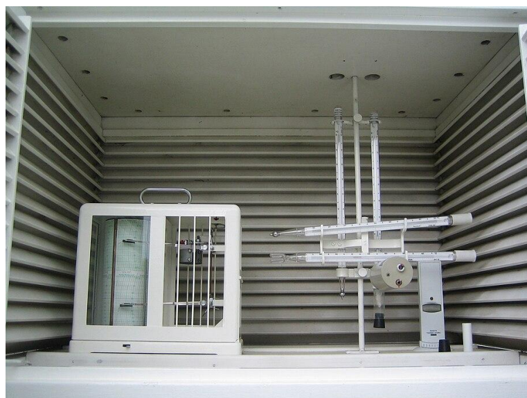
Strahlungsschutzhütte aus eloxiertem Aluminium mit weißer Lackierung.
