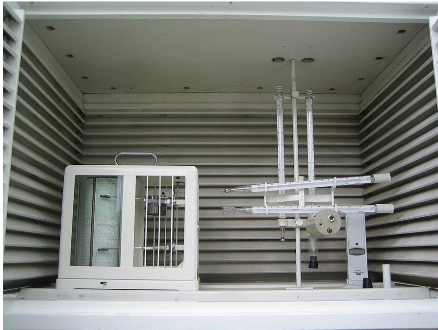
Englische Wetterhütte Instrumentendarstellung (rechts: Psychrometer nach August, links: Thermohygraph)
