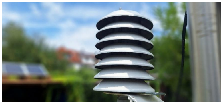
Strahlungsschutzhütte aus eloxiertem Aluminium mit weißer Lackierung.
