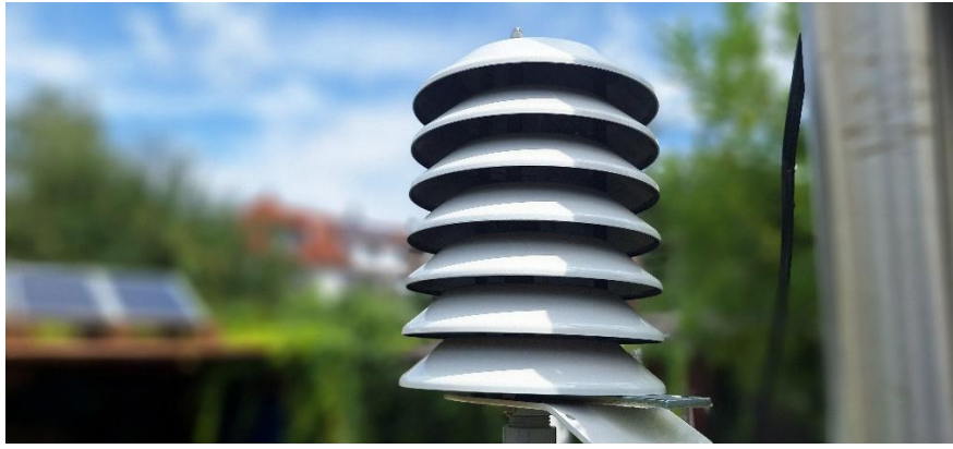
Strahlungsschutzhütte aus eloxiertem Aluminium mit weißer Lackierung.
